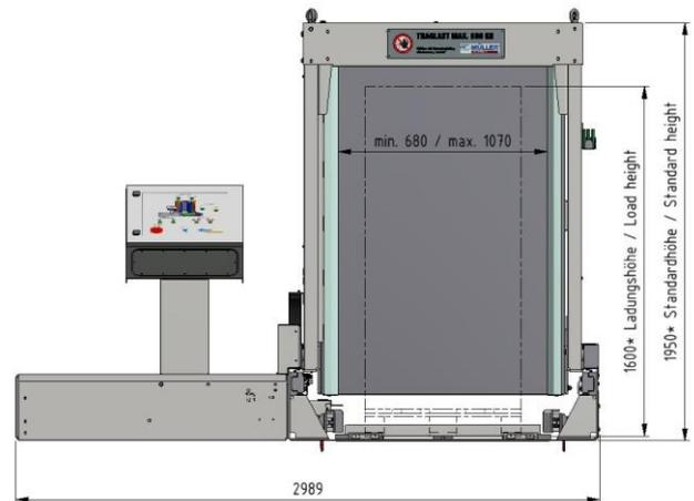
\*1) Im automatischen Betrieb müssen zum Personenschutz trennende sowie berührungsloswirkende Schutzvorrichtungen (Lichtgitter) vorgesehen werden.
