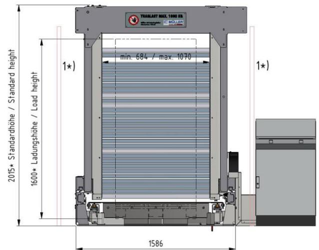
\*1) Im automatischen Betrieb müssen zum Personenschutz trennende sowie berührungsloswirkende Schutzvorrichtungen (Lichtgitter) vorgesehen werden.
